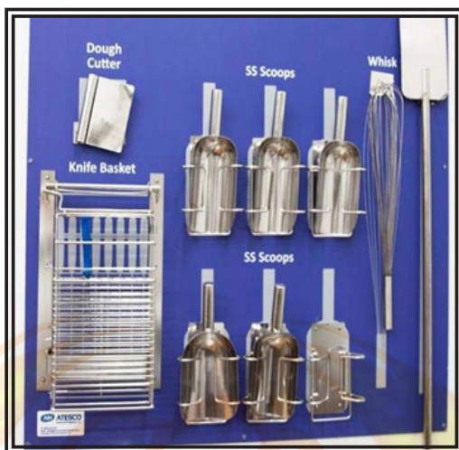
تصویر ۱۲-۱ مثال یک، استفاده از تخته سایه بعنوان راهکار اصل چهارم نظام آراستگی (استاندارد سازی) برای مرتب سازی ابزار کار
